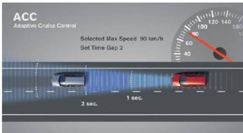
Figura 2.4: O Sistema ACC mantém uma distância de segurança ao veículo da frente conforme a velocidade máxima desejada e a diferença de tempo mínima introduzidas pelo condutor no sistema.
