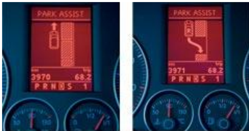
Figura 2.9: Assim que o sistema detectar um espaço de estacionamento potencialmente adequado, tal é sinalizado opticamente. Quando o veículo se encontrar na posição ideal perante esse espaço, é sinalizado com uma seta e o condutor pode iniciar a manobra.
