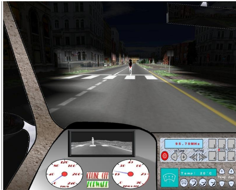
Figura 5.2: Interface do sistema de visão noturna integrada no simulador
