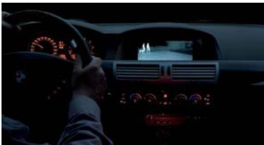
Figura 2.7: Sistema Night Vision . A imagem é representada com um contraste de preto e branco no monitor.
