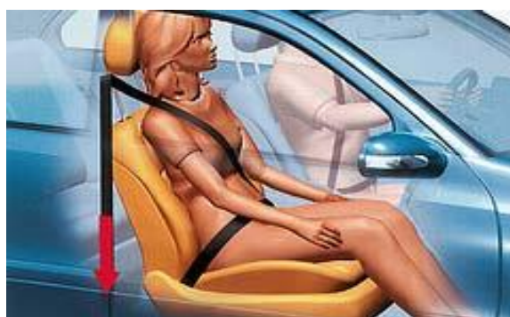
Figura 2.1: O sistema PRE-SAFE reconhece situações de risco através de sensores e posiciona os passageiros automaticamente para a posição mais segura antes do acidente.
