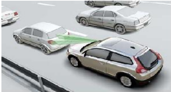
Figura 2.3: Volvo City-Safety-System : Evita embates entre veículos através de sensores.
