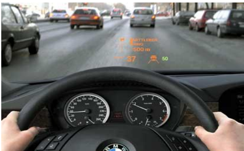
Figura 2.6: A figura apresenta o Sistema Head-Up Display , onde está projectada no pára-brisas informação.
