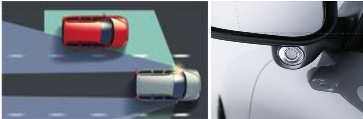
Figura 2.2: O Sistema de Informação Blind Spot vigia o ângulo morto numa área de nove metros e meio de comprimento e três metros de largura.
