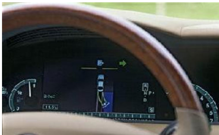
Figura 2.8: Com a ajuda de sensores o novo sistema de estacionamento da Mercedes reconhece um espaço de estacionamento adequado.
