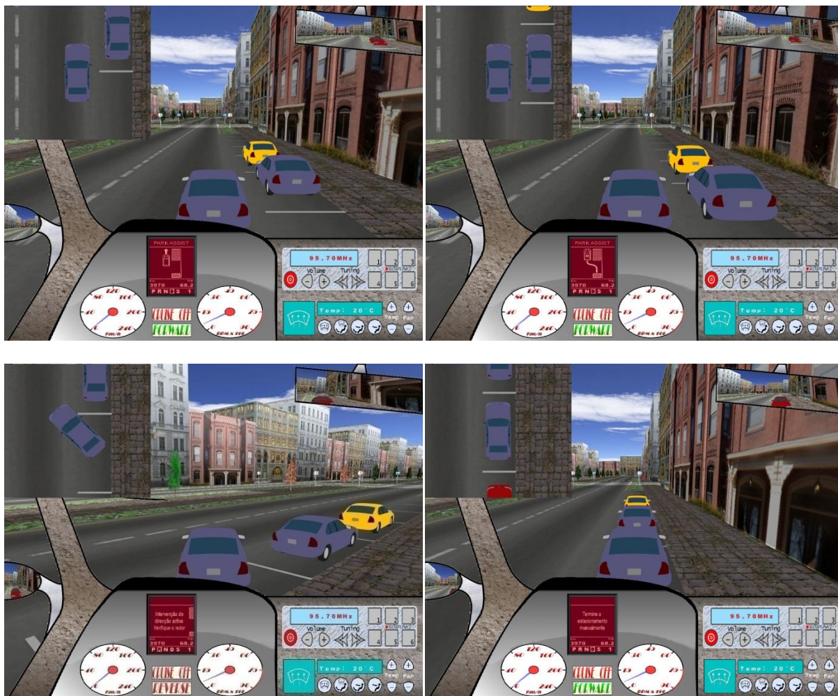
Figura 5.6: Processo de estacionamento paralelo com o sistema de estacionamento automático no simulador
