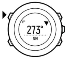
A bússola passa automaticamente para o modo de poupança de energia após um minuto. Volte a ativar a bússola com [Iniciar/Parar].
