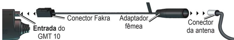
2. Ligue o conector Fakra do cabo adaptador ao conector de **Saída** do GTM 10. Ligue o conector macho (ficha) do cabo adaptador à tomada do rádio, conforme a seguir ilustrado.
