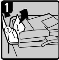
· Abra a tampa ARDF e, de seguida, retire o original encravado.
