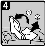
· Se não conseguir retirar o original encravado, abra a tampa externa do ARDF e, de seguida, retire o original encravado.
