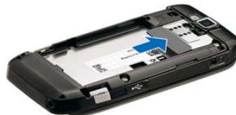
4. Introduza a bateria. Alinhe os contactos da bateria com os conectores correspondentes do compartimento da bateria e insira-a na direcção da seta.
