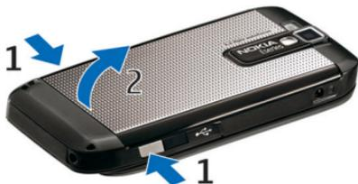
2. Se a bateria estiver instalada, levante-a na direcção da seta, para a remover.
