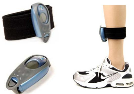
Figura 4.16 Sistema PAM (*Patient Activity Monitor*) produzido pela *Ossur* (imagem adaptada de [www.ossur.com]).
