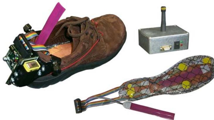
**Figura 4.20** Componentes do sistema protótipo SIGSS (imagem adaptada de [www.media.mit.edu]).
