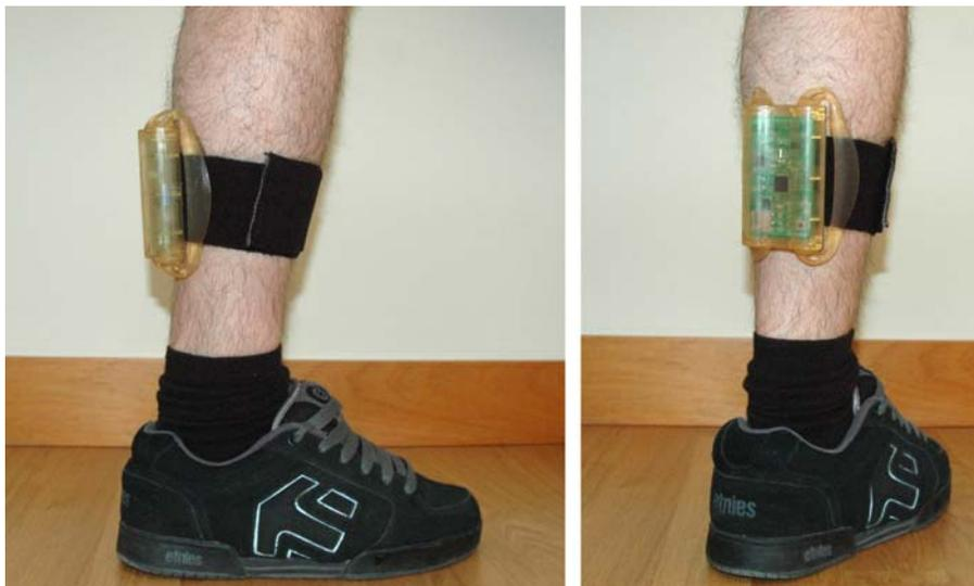
**Figura 5.12** Teste da fixação do módulo tecnológico pela utilização de uma cinta elástica experimental.
