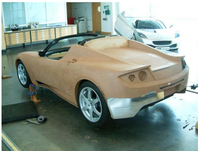
**Figura 2.9** Protótipo físico de um automóvel eléctrico *Tesla*, focado na análise específica da forma e da aerodinâmica. O modelo é construído numa pasta moldável à base de argila (imagem de [www.teslamotors.com]).
