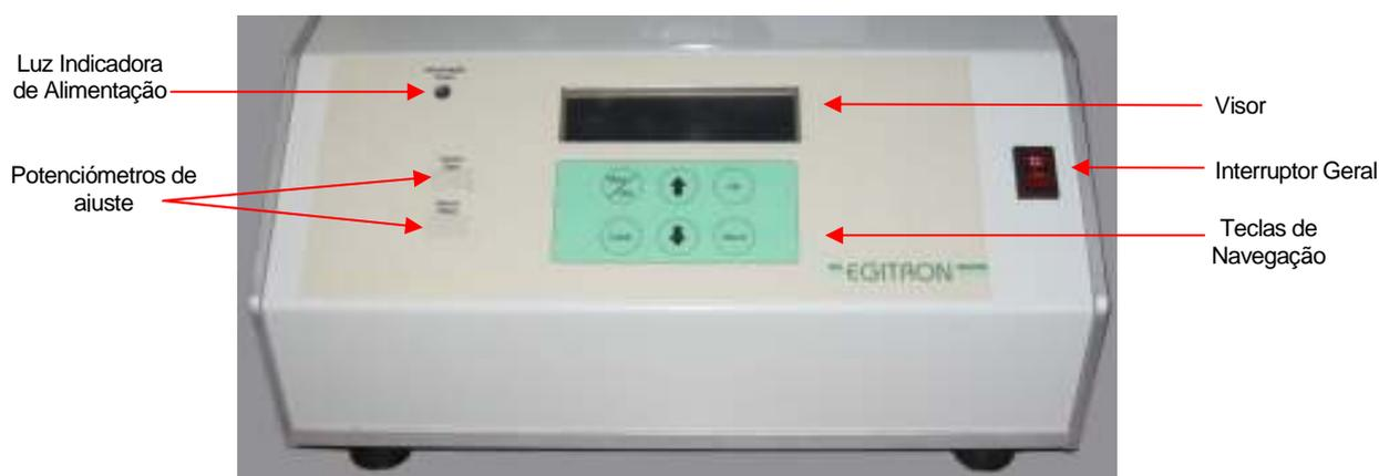
Figura 8 – Painel Frontal da Caixa de Comando
