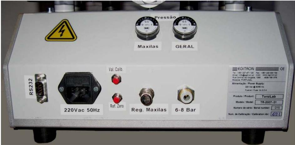
Figura 6 – Painel Traseiro da Caixa de Comando
