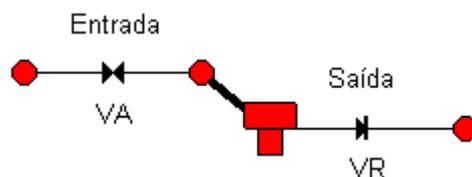
A tubagem de entrada no reservatório é composta por uma Válvula de Alívio (VA), que assegura que a pressão a montante é sempre superior ao nível no RNV, seguida de um troço de tubagem curto de diâmetro elevado (i.e., tubagem
