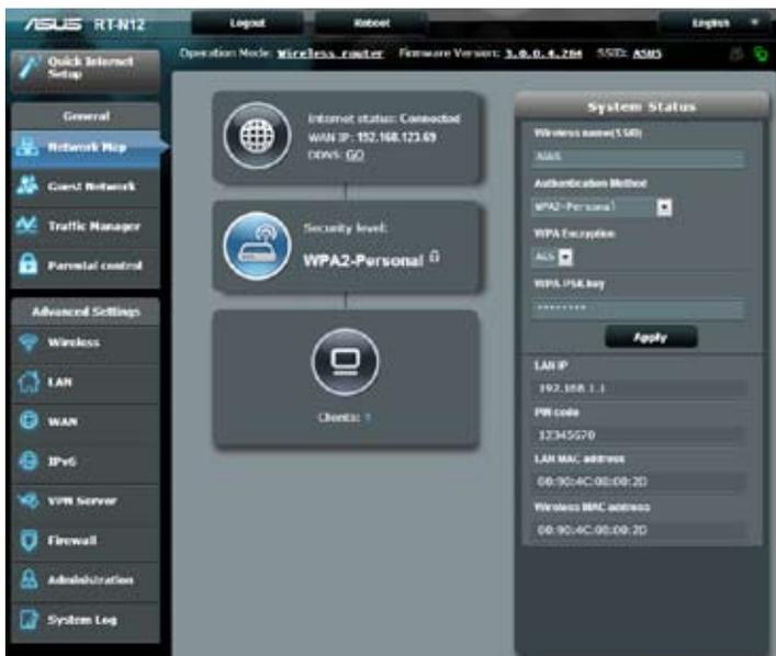
4. No campo **Wireless name (SSID) (Nome da rede sem fios (SSID))**, introduza um nome exclusivo para a sua rede sem fios.
