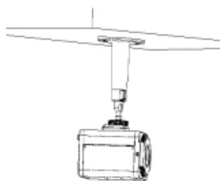
6. Ligue um cabo de vídeo coaxial de 75 ohm ao cabo de vídeo, e ligue uma fonte de alimentação de 12 VCC ao cabo de alimentação.
