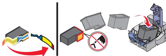
**Aviso—Dano Potencial:** *não* toque na área de contato dourada na parte posterior nem nos orifícios de metal na parte inferior do cartucho.
