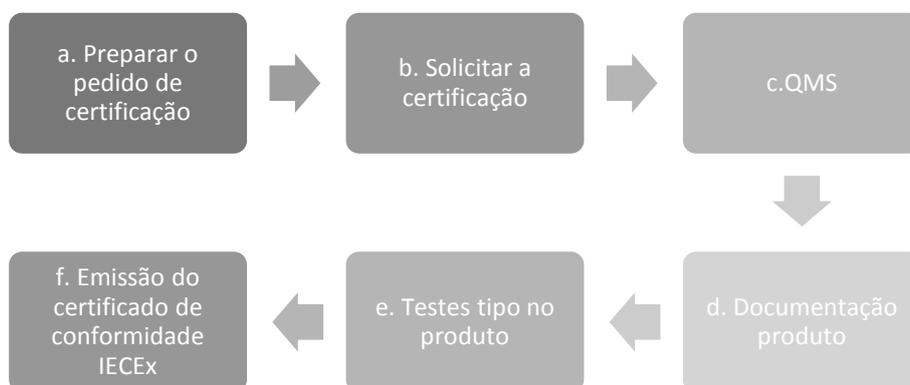
**Figura 34** – Processo de certificação de um produto através do esquema IECEx.
