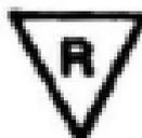
*Figura 17 - Etiqueta equipamento reparado segundo as normas mas sem conformidade com os documentos de certificação [42]*
