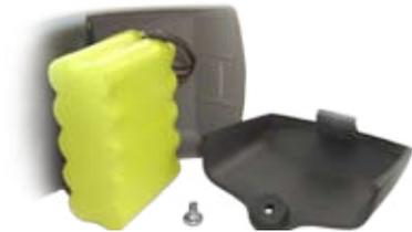
Remova a tampa da bateria e desligue a bateria actual.
