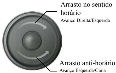
O medidor é controlado utilizando uma roda sensível ao toque e um botão de selecção distinto no centro da roda.
