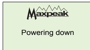
Para desligar o medidor, mantenha premido o botão de Seleção, (como quando liga o medidor).
