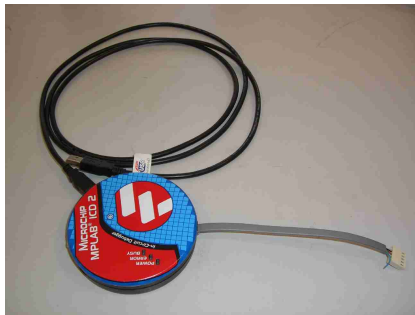
(16) Cabo USB (PC) + Cabo de programação (Slave principal)
