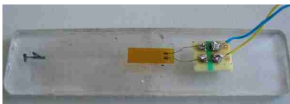
Fig. 26: Peça de acrílico contendo o extensómetro para medição da sua deformação.
