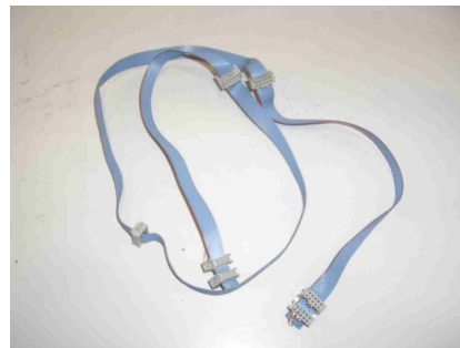
(20) Barramento CAN de ligação a todas as unidades controladoras
