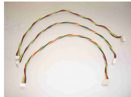
(21) Cabos de ligação dos servos ao Slave principal.
