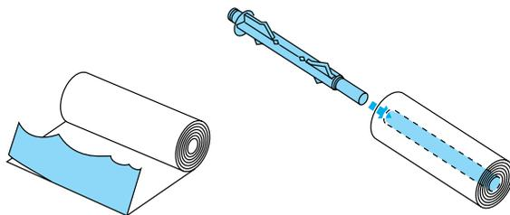
5. Coloque o eixo e o rolo do papel no suporte. Coloque o eixo e o rolo do papel no suporte. Em seguida, ligue a impressora.
