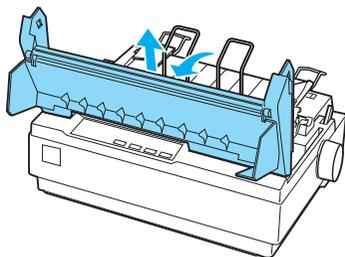
3. Os utilizadores da 1170II devem retirar o tensor de papel apertando levemente as respectivas patilhas de fixação e puxando o tensor de papel para fora da impressora.
