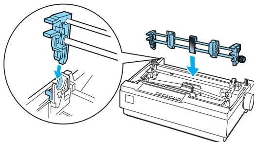
Os utilizadores da LX-1170II devem utilizar as duas mãos para agarrar no tractor posterior. Empurre o tractor para baixo, para a ranhura de montagem situada na parte superior da impressora, e incline-o para o inserir no lugar, como se mostra abaixo. Ao empurrar o tractor contra os pinos, deve sentir as ranhuras encaixar no lugar.
