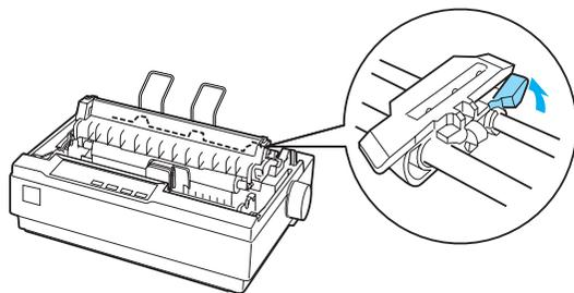
3. Desloque a correia de tracção esquerda, utilizando a régua da impressora como guia. A impressora imprime à direita da posição com a marca 0. Empurre a alavanca de fixação da correia para trás, para a fixar no lugar. Em seguida, desloque a correia de tracção direita para a ajustar à largura do papel, mas não a fixe. Desloque o suporte de papel para a posição central, entre as correias de tracção.
