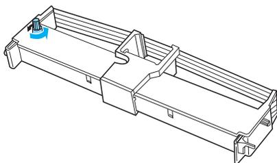
6. Insira a cassete de fita na impressora, conforme se mostra; em seguida, carregue com firmeza em ambos os lados da cassete, para encaixar os ganchos de plástico nas ranhuras da impressora.
