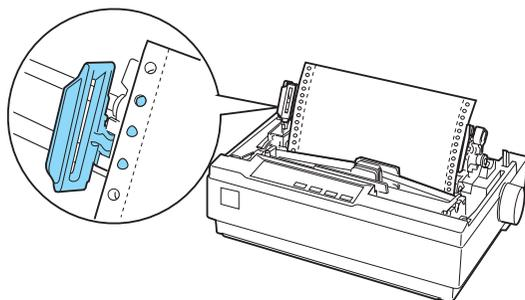
8. Para separar o papel alimentado do papel impresso, instale a guia de papel. Segure-a na horizontal e encaixe as respectivas ranhuras nos pinos de montagem da impressora. Em seguida, desloque a guia de papel para a parte de trás da impressora, até encaixar no lugar e produzir um estalido, e ajuste as guias das margens à largura do papel.
