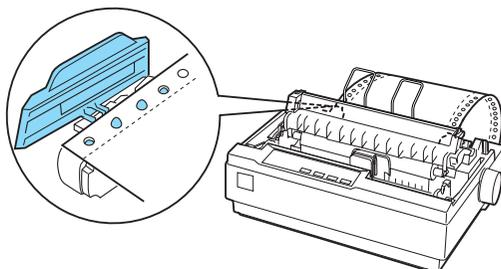
5. Para separar o papel alimentado do papel impresso, prenda a guia de papel segurando-a na horizontal e encaixando as respectivas ranhuras nos pinos de montagem da impressora, como se mostra abaixo. Em seguida, desloque a guia de papel para a frente da impressora, até encaixar no lugar e produzir um estalido, e ajuste as guias das margens à largura do papel.
