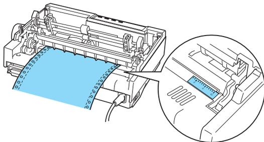
6. Desloque a correia de tracção esquerda para a ajustar à posição dos orifícios do papel e fixe a correia no lugar. Em seguida, desloque a correia de tracção direita para a ajustar à largura do papel, mas não a fixe. Desloque o suporte de papel para a posição central, entre as duas correias de tracção.
