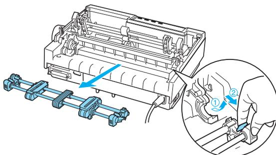
3. Desloque o tractor para a frente, para a ranhura de montagem situada na parte superior da impressora, e incline-o para o inserir no lugar, como se mostra abaixo. Ao empurrar o tractor contra os pinos, deve sentir as ranhuras encaixar no lugar.
