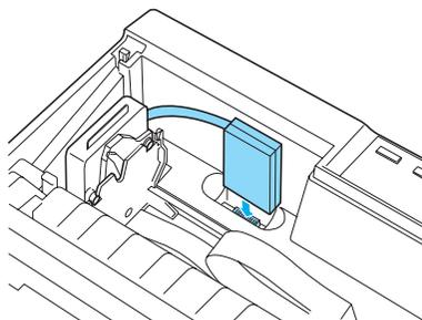
4. Desloque a cabeça de impressão para o centro da impressora; em seguida, desloque a parte de plástico da fita de cores para o centro da cassette.
