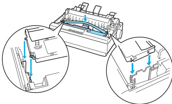
8. Utilize um objecto pontiagudo, como uma esferográfica, para orientar a fita entre a cabeça de impressão e a guia da fita.
