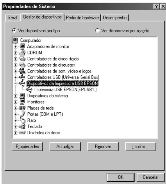
Se a indicação Dispositivos da Impressora USB EPSON não aparecer no menu Gestor de dispositivos, faça clique no sinal de mais (+) situado ao lado de Outros dispositivos para visualizar os dispositivos instalados.
