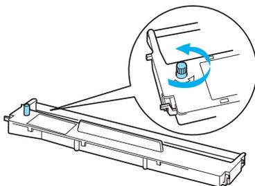
7. Insira a cassete de fita na impressora, conforme se mostra; em seguida, carregue com firmeza em ambos os lados da cassete, para encaixar os ganchos de plástico nas ranhuras da impressora.
