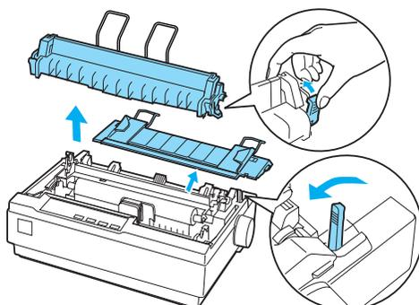
2. Aperte levemente as patilhas de fixação do tractor, em ambos os lados, e rode o tractor para cima para o puxar para fora da impressora.
