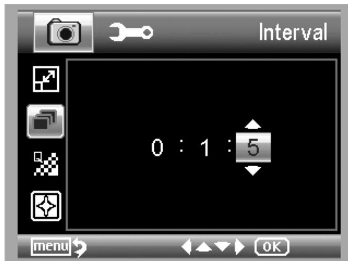
**Intervalo:** Entradar o tempo de intervalo entre a captura de quadro por CIMA/BAIXO e ESQUERDA/DIREITO. A configuração acima significa intervalo de tempo é de 15 segundos entre cada duas capturas.
