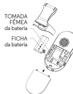
O equipamento é fornecido com uma bateria recarregável que deve ser instalada, de modo a que a unidade do progenitor possa ser movida sem perder a ligação e a imagem da(s) unidade(s) do bebé. Carregue a unidade do progenitor antes de a utilizar pela primeira vez ou quando a unidade do progenitor indicar que a bateria tem pouca carga.
