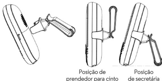
1. O prendedor para cinto/suporte é instalado na parte traseira da unidade de progenitor e prende-se nas ranhuras de bloqueio existentes em cada lado.
