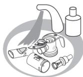
**I DESINFETE** a câmara nebulizadora desmontada e os acessórios utilizados diariamente (exceto a mangueira de ligação) logo a seguir à limpeza (a câmara nebulizadora só pode ser bem desinfectada se estiver limpa).
