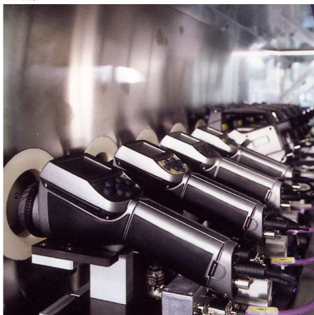
Figura 18.4 ESQUERDA: Teste das câmaras de infravermelhos na câmara climática; DIREITA: Robô para testar e calibrar as câmaras
