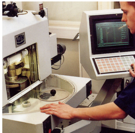
Figura 18.3 ESQUERDA: Torno para trabalhar diamantes; DIREITA: Polimento da lente
