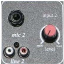
A Entrada n° 2 tem 1 entrada Micro Jack mono (6,35 mm), 1 entrada Linha com 2 conectores RCA e um controlo de volume. A selecção da entrada é automática.
