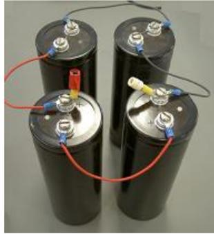
Figura 25 – Ligação dos condensadores
