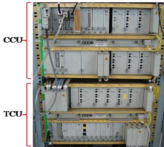
Figura 7 – Torre da CCU e da TCU
