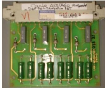
**Figura 12 – Unidade de conexão de impulsos actuadores**
