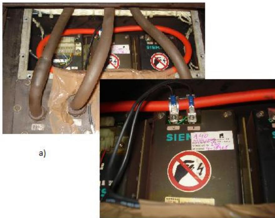
Figura 41 – Ligações efectuadas no comboio.
