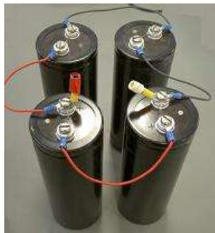
Figura 18 - Configuração dos condensadores no circuito
