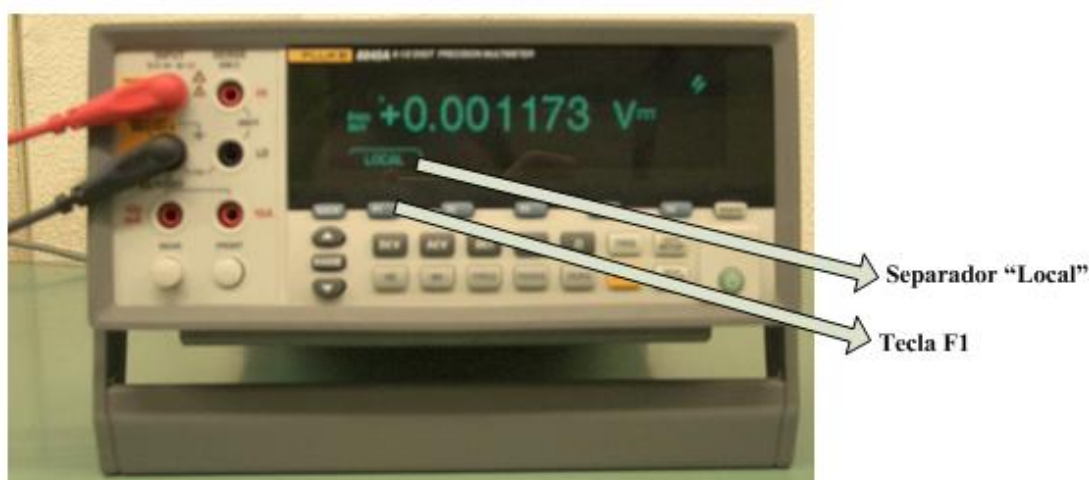
Figura 12 - Multímetro com medição remota de tensão contínua
