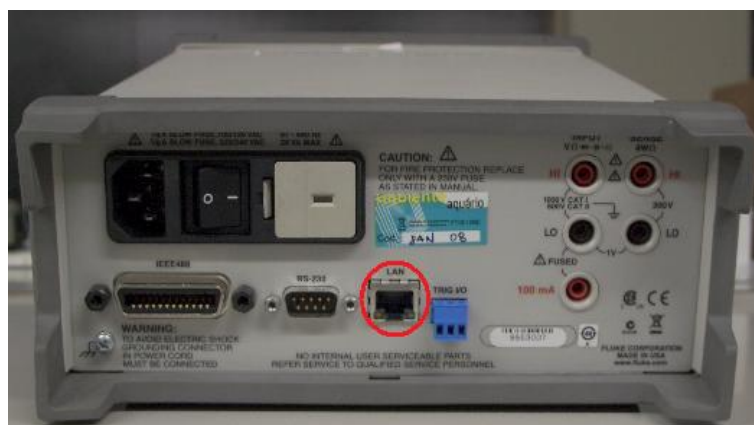
Figura 10 - Vista traseira do multímetro
