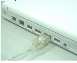
Introduza o conector USB numa porta USB disponível no seu computador ou portátil, de acordo com este diagrama. Após a detecção da mesa, o Windows tentará instalar um driver de dispositivo para ela.
