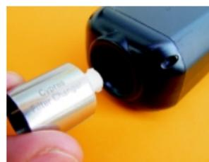
Segurar a peça de mudança de filtro pela parte que não tem ranhuras, inseri-lo gentilmente dentro da unidade sem torcer. Rodar a peças no sentido dos ponteiros do relógio, no início irá sentir alguma resistência, continuar a rodar até encaixar dentro do filtro. O filtro pára de rodar mas a peça continua. Remover a peça de fixação do filtro puxando-a para trás.
