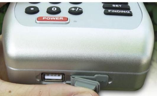
Interface USB para conectar o dispositivo ao PC, ao lado do soquete de alimentação de energia.
