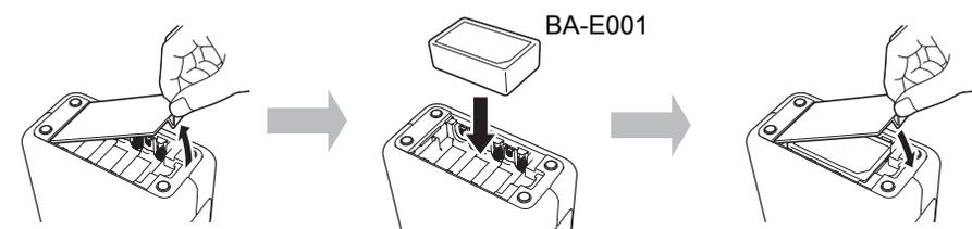
Para retirar a bateria recarregável de íões de lítio, realize o procedimento de instalação pela ordem inversa.
