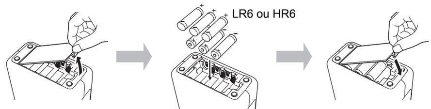
Para retirar as pilhas, realize o procedimento de instalação pela ordem inversa.
