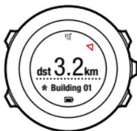
Enquanto se desloca (>4 km/h), o dispositivo exibe a direção para o PDI (ou ponto de referência, se estiver a navegar um percurso) com base em GPS.
