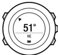
A bússola passará automaticamente para o modo de poupança de energia após um minuto. Volte a ativar a bússola com [Start Stop] (Iniciar Parar).
