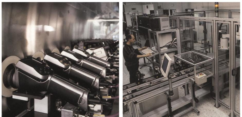
Figura 14.5 ESQUERDA: teste das câmaras de infravermelhos na câmara climática; DIREITA: robô para testar e calibrar as câmaras
