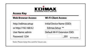
4. Abra um Web browser e se o ecrã "Introdução" indicado abaixo não aparecer automaticamente, introduza o URL http://edimax.setup e clique em "Introdução" para iniciar o processo de instalação.
