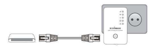
Seleccione o modo "Access Point" (Ponto de acesso) durante a configuração (consulte **II. Passo de instalação 5**) e siga as instruções no ecrã. Quando a configuração for concluída, ligue o dispositivo Wi-Fi ao novo SSID do ponto de acesso.
