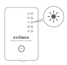
**3.** Utilize um dispositivo Wi-Fi (por exemplo, computador, tablet, smartphone) para procurar uma rede Wi-Fi com o SSID "Edimax.Setup" e ligá-lo.
