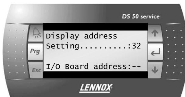
Usando as teclas ↑ ↓ altere a definição dos endereços do visor para 0 (em vez de 32 como valor standard) e valide com a tecla ↵ .
