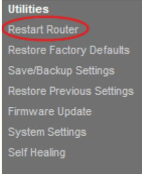
Clique em "Restart Router" (Reiniciar o router) na coluna do lado esquerdo por baixo do cabeçalho "Utilities" (Utilitários).
