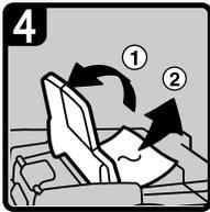
4 · Se não conseguir retirar o original encravado, abra a tampa externa do ARDF e, de seguida, retire o original encravado.
