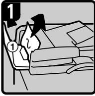
1 · Abra a tampa ARDF e, de seguida, retire o original encravado.
