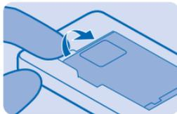
3. Levante o suporte do SIM, e insira o SIM com a área de contacto virada para baixo.
