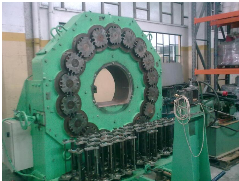
Figura 2.1 - Máquina de entrançar que será adaptada para o projecto.
