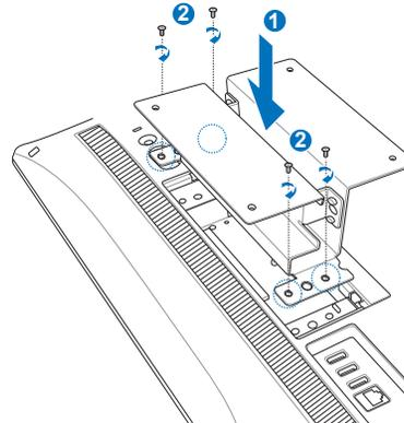
4. Fixe o suporte para montagem na parede ao adaptador utilizando os quatro parafusos (M3 x 8L) incluídos no kit, observando a orientação correcta.
