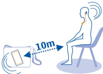
Este dispositivo é compatível com a Especificação Bluetooth 2.1 + EDR e suporta os seguintes perfis: Headset Profile (HSP) 1.2, Hands-Free Profile (HFP) 1.5, Advanced Audio Distribution Profile (A2DP) 1.2 e Audio Video Remote Control Profile (AVRCP) 1.0. Consulte os fabricantes dos outros dispositivos, para determinar a respectiva compatibilidade com este dispositivo.
