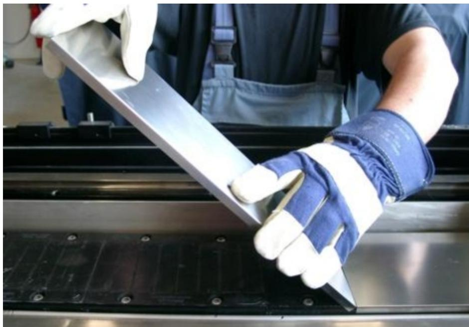
Imagem 5-7 Montagem de um outro segmento da cobertura da secção secundária segmentada
