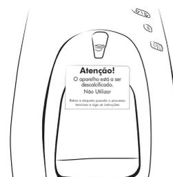
13 O processo de descalcificação está concluído. Retire a etiqueta. O aparelho está pronto a funcionar.
