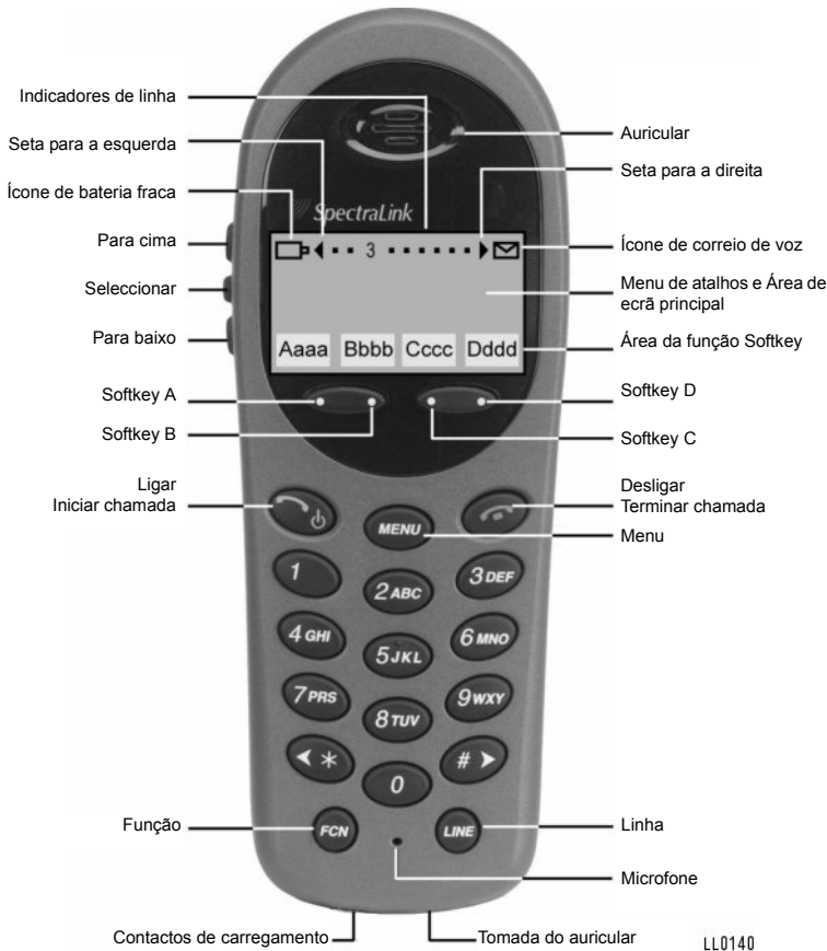
Figura 1: SpectraLink NetLink e340
