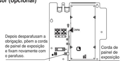
Depois desparafusam a obrigação, põem a corda de painel de exposição e fixam novamente com o parafuso.
