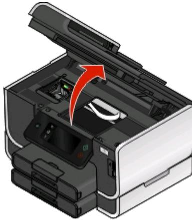
**Nota:** A cabeça de impressão move-se para a posição de instalação do tinteiro.
