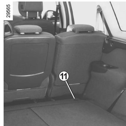
Se o veículo estiver equipado com os anéis de retenção **11**, deve retirá-los antes de instalar uma rede de separação de bagagens.
