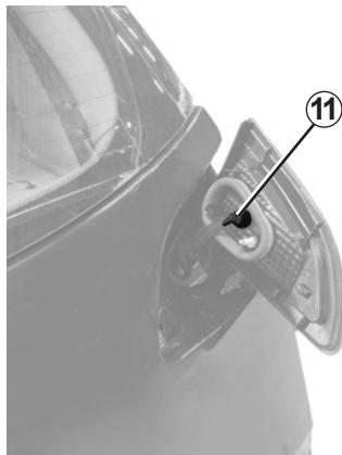
A partir do exterior do veículo, puxe o bloco de luzes, para o extrair, e rode o porta-lâmpada **11** um quarto de volta.
