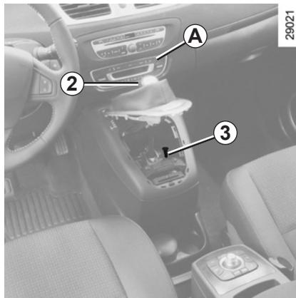
**Ao pôr o motor a trabalhar**, se a alavanca ficar bloqueada na posição **P**, com o pé no pedal de travão e o botão de destravamento **2** premido, é possível desbloqueá-la manualmente. Para isso, desencaixe a base da alavanca de velocidades, começando pelo lado situado sob os comandos **A** do ar condicionado, e prima simultaneamente o botão **3** e o botão de destravamento **2** situado na alavanca.
