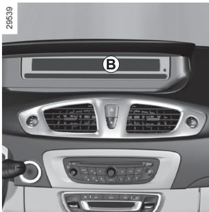
**Quadro de instrumentos A** ou **B**: ilumina-se ao ligar a ignição.
