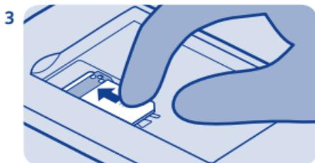
Faça deslizar o SIM por baixo do suporte com a área de contacto virada para baixo.
