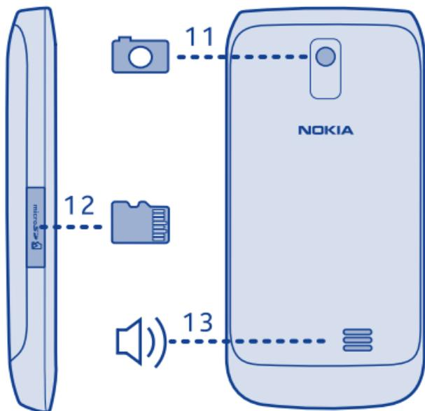
**11** Lente da câmara. Antes de utilizar a câmara, remova a película protectora da lente.
