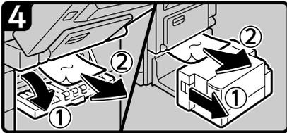
Se não conseguir retirar o papel encravado, abra a tampa. Se a máquina estiver equipada com LCT, deslize-o para a direita.
