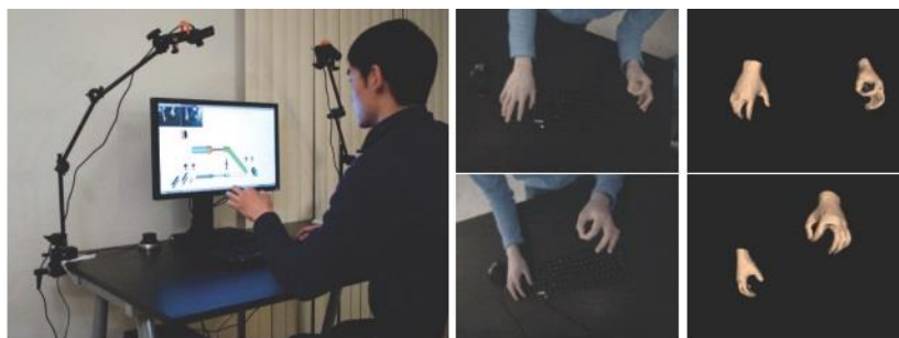
Figura 2.12 - Captação dos gestos de um utilizador recorrendo ao sistema desenvolvido por [Wang et al.2011].
