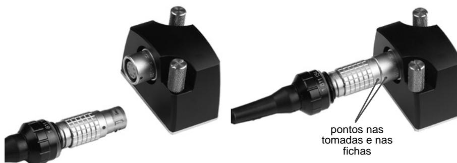
Figura 2-10. Ficha da Palm Control Unit e adaptador UA1271.
