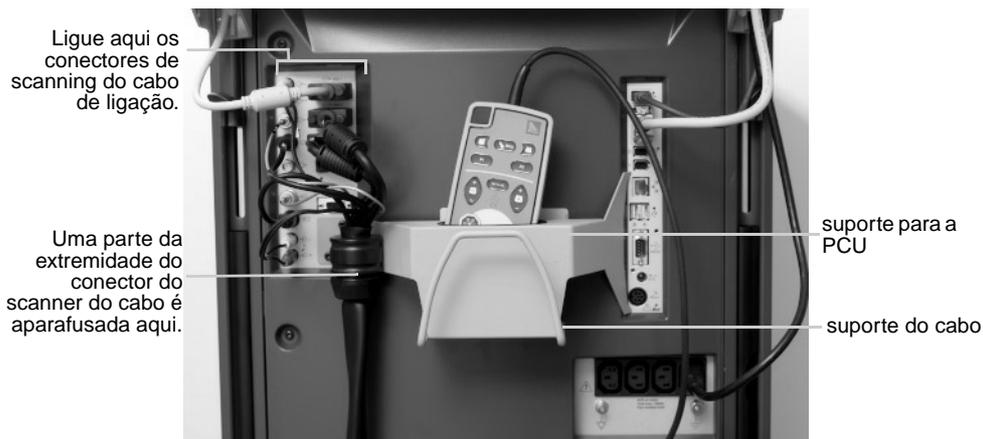
Figura 5-10. O suporte para o cabo de ligação e PCU instalados na parte de trás do scanner.
