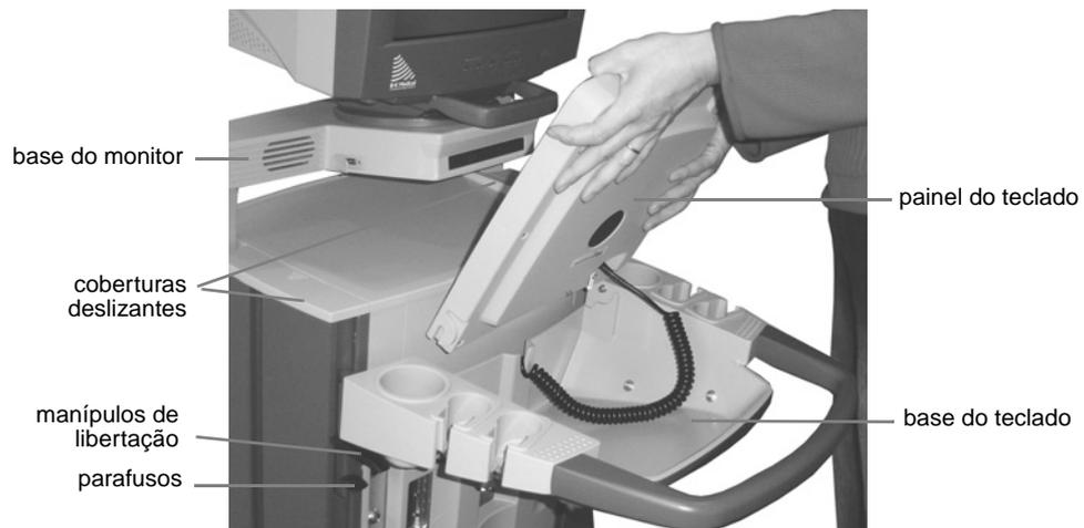
Figura 5-13. Remoção da base do teclado.
