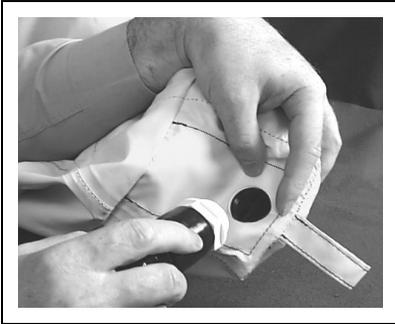
4. Certifique-se de que o orifício de entrada do tubo do capuz está bem alinhado com o do capacete. Instale o tubo no capacete/capuz (consultar *Para substituir o tubo* para mais detalhes).
