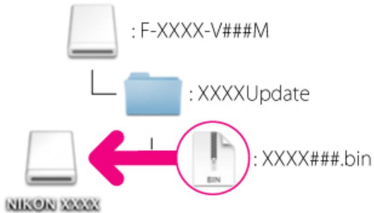
Quando a cópia ficar completa, confirme que o volume da câmara contém o "XXXX###.bin".
