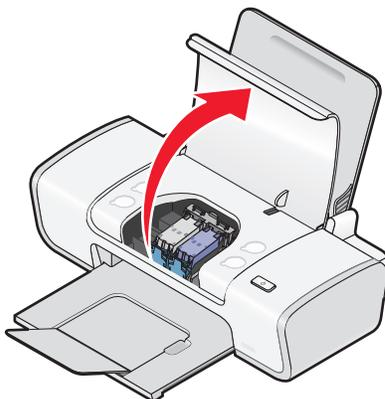
**3** Pressione a alavanca do suporte do tinteiro para levantar a tampa do suporte do tinteiro.
